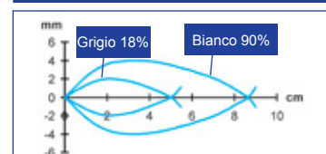
Area di rilevazione - radiale
