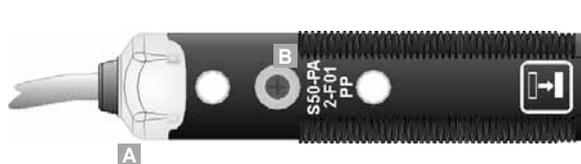
Trimmer monogiro per la regolazione della sensibilità. Ruotare in senso orario per aumentare la distanza operativa..
