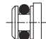
tappo per montaggio valvola 3/2 CP-112 per G1/8, CP-9112 per G1/4 materiale: alluminio
